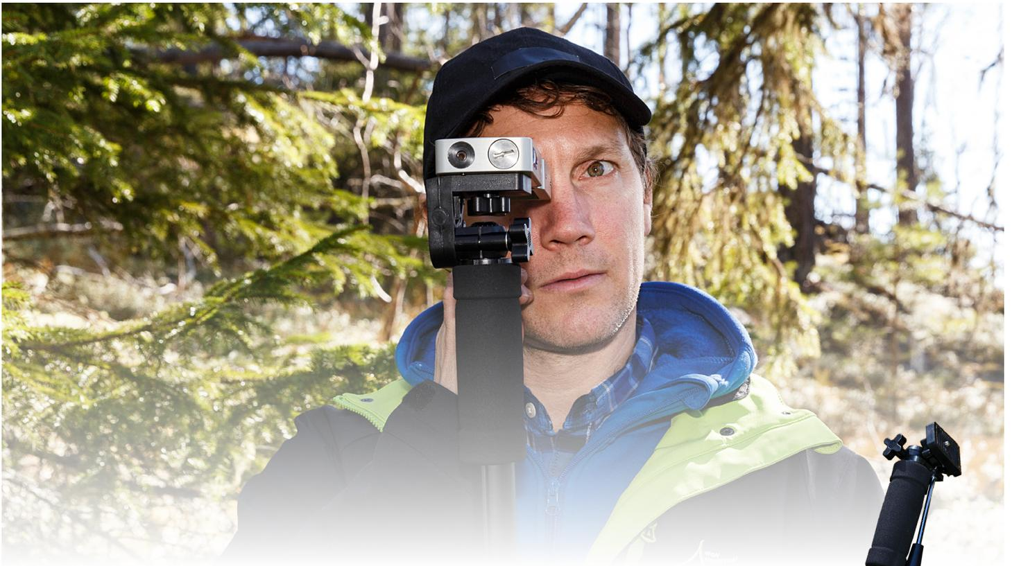
Der TrailBlazer hat ein ausgewogenes und robustes Gehäuse aus eloxiertem Aluminium mit eingebautem Standard-1/4"-Montagepunkt für Einbeinstativ (falls benötigt).
