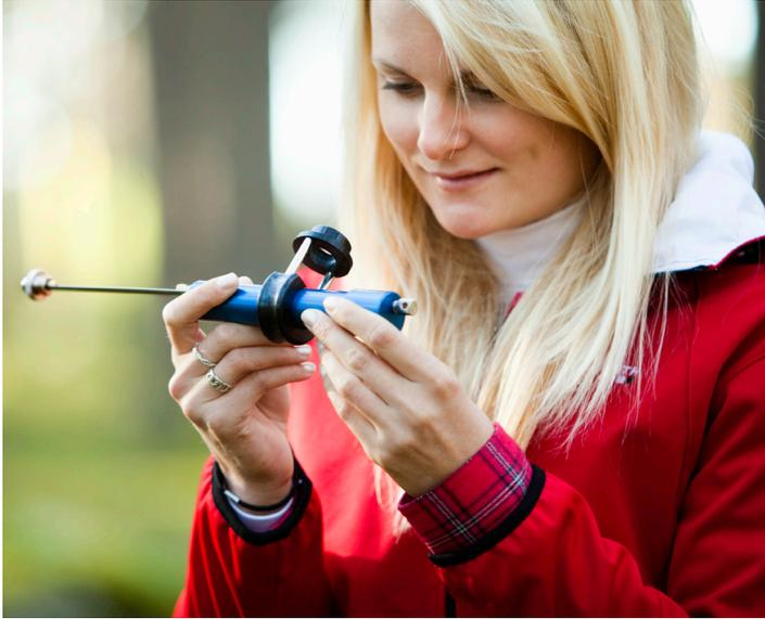
Les tarières Haglöf Sweden sont utilisées pour déterminer l'accroissement, l'âge et la qualité des arbres. Un noyau de bois extrait offre des détails internes sur l'âge des arbres, l'augmentation, le climat, la fertilisation, le taux de croissance, l'approvisionnement en eau, les incendies, les dommages antérieurs et les maladies. Le noyau est précieux tant
