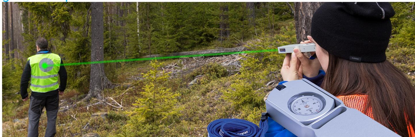
Le TrailBlazer® est une solution instrumentale dotée d'un pointeur laser vert, conçu pour s'adapter aux plus grandes marques de boussoles. Utilisez un laser vert à haute visibilité pour localiser les bordures et les limites.
