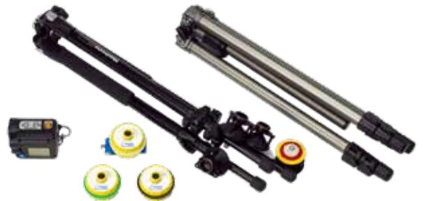
*Postex Laser ist unser häufigst verwendetes Modell und wird oft in Verbindung mit einer Computerkluppe von Haglöf Sweden benutzt. Postex Laser kann auch mit anderen Datensammlern zur Positionierung von individuellen Objekten im Wald und Feld eingesetzt werden.*
