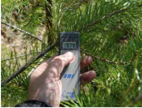
DME verwendet Ultraschalltechnologie zur Entfernungsmessungen im schwierigen Gelände und dichtem Unterholz. Messen Sie bis zu 30 Meter für die Kreisflächen!
