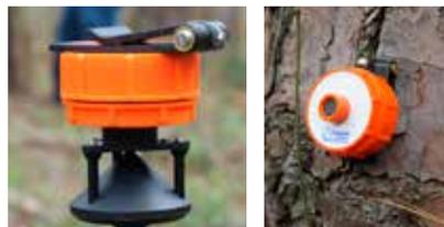
*Der Transponder T3 wird mit Vertex IV, Vertex Laser und DME Entfernungsmesser verwendet. T3 dient als Referenzpunkt bei der Ultraschallmessung und hat eine gut sichtbare Farbe. Er ist sehr widerstandsfähig und kann direkt an einem Baumstamm oder einem Adapter mit unserem speziell angepassten, verstärkten Teleskopstab befestigt werden.*
