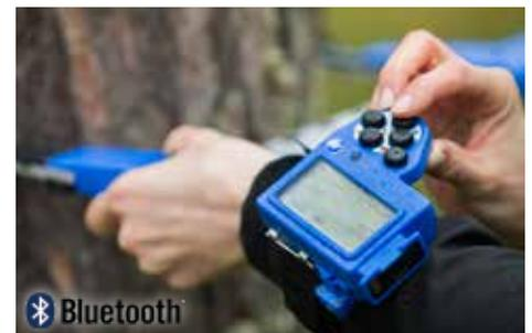
*DP II Computerterminal am Handgelenk. In diesem Fall wird SmartScale separat als Kluppe zur Durchmesser-messung am Baum verwendet. Eine werkseitig montierte Radio Enter-Taste am beweglichen Griff ermöglicht dieses Verfahren und das Senden von Messwerten von SmartScale an den Computerterminal.*
