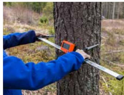
MD II ist mit patentierten, zusammenklappbaren Schenkeln zur Verwendung in dickem Wald versehen. Eine zusätzliche Enter-Taste für den rechten Zeigefinger erleichtert die Arbeit. Sie können kreuzskalieren und MD II den Umkreiswert, statt des Durchmessers, im Display anzeigen lassen. MD II ist die richtige Wahl, wenn grosse Mengen von stehendem Holz gemessen werden sollen und für diejenigen, die bevorzugen die sonstige Arbeit auf einem Handcomputer oder PC im Büro zu erledigen.
