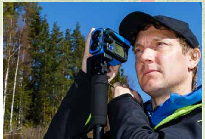
*3D Pile und Laser Geo ermöglichen Ihnen, das Volumen unregelmäßiger Objekte, z. B. Holzhackschnitzel-Mieten zu schätzen. Verwenden Sie ein nicht-magnetisches Einbeinstativ für bessere Stabilität. Messen, verarbeiten, speichern, übertragen – alles in einem kompakten Gerät.*
