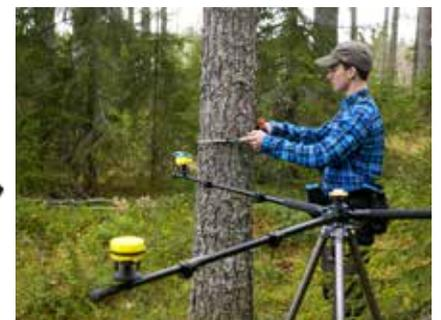
Art nr 15-103-1047 DP Postex mit Stativ und Transpondersystem: Transponder A, B und C mit Dreibein-stativ, Adapter/Adapter für Transponder und Libelle.
