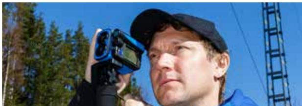
*GPS- und Kompassfunktion mit einer Genauigkeit von < 1,5 Grad RSME (Root Mean Square Error - Mittlerer quadratischer Fehler) im Instrument integriert und Head-up-Display zur Aktualisierung der Messung in Echtzeit.*
