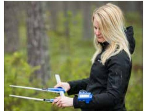
Kurzspezifikation: 2.45Ghz, GFSK 1Mbps. Funk: Intern, binär. 1x CR2032 Batterie, Betrieb ca. 1 Jahr. Wenn Sie DP II mit Radio Enter-Taste wählen, entfällt die mechanische Taste am Griff des Standardmodells von DP II Kluppe.
