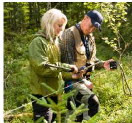
*Faden mindestens viermal um das Messrad wickeln, Fadenende beim Ausgangspunkt befestigen, Zähler zurückstellen und losgehen!*
