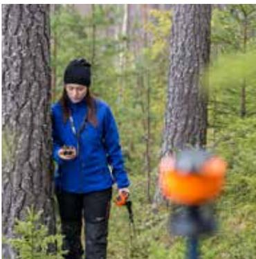
*Vertex Laser Geo ermöglicht es Ihnen, zusammen mit dem T3-Transponder Entfernungen in dichter Vegetation mit Ultraschall zu messen.*
