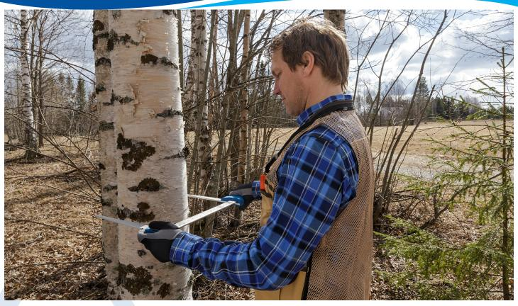
Ces bastringues robustes en aluminium donnent des mesures de diamètre précises. Mâchoires de mesure réglables et coulissantes. Gradué des deux côtés. Graduations robustes en aluminium avec impression claire, visible et durable.
