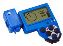
Le module DP GPS vous permet d'effectuer des travaux de navigation et de positionnement avec le bastringue informatisé. Utilisez le DP GPS pour revisiter des parcelles et des zones mesurées.
