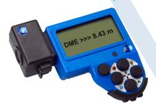
Le DP DME donne une mesure de distance du centre de l'arbre au centre de la parcelle. Le DP DME associé au transpondeur T3 mesure les distances avec la technologie des ultrasons, de sorte que la végétation dense avec sous-bois ne pose aucun problème avec ce système.
