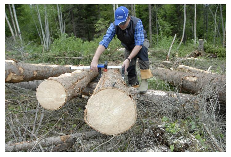
Le fil de mesure du ruban Digitech est composé de plusieurs fils métalliques tressés, qui forment ensemble un fil solide, flexible mais non extensible, facile à manipuler et qui s'étend jusqu'à environ 7 mètres/yd.
